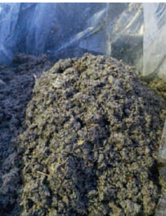
Refus extraits en aval des prétraitements, sur le tamiseur RoK4 à tôle perforée 3 mm, 10 tonnes/an
