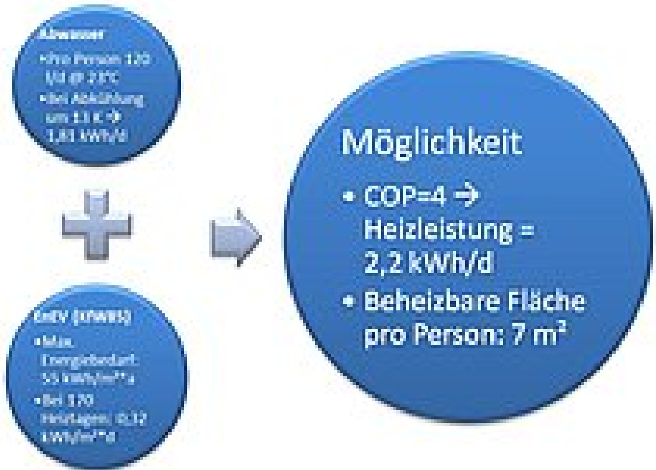
Abbildung 2: Beispielrechnung für die tägliche Abwasserenergie-Produktion pro Kopf.
