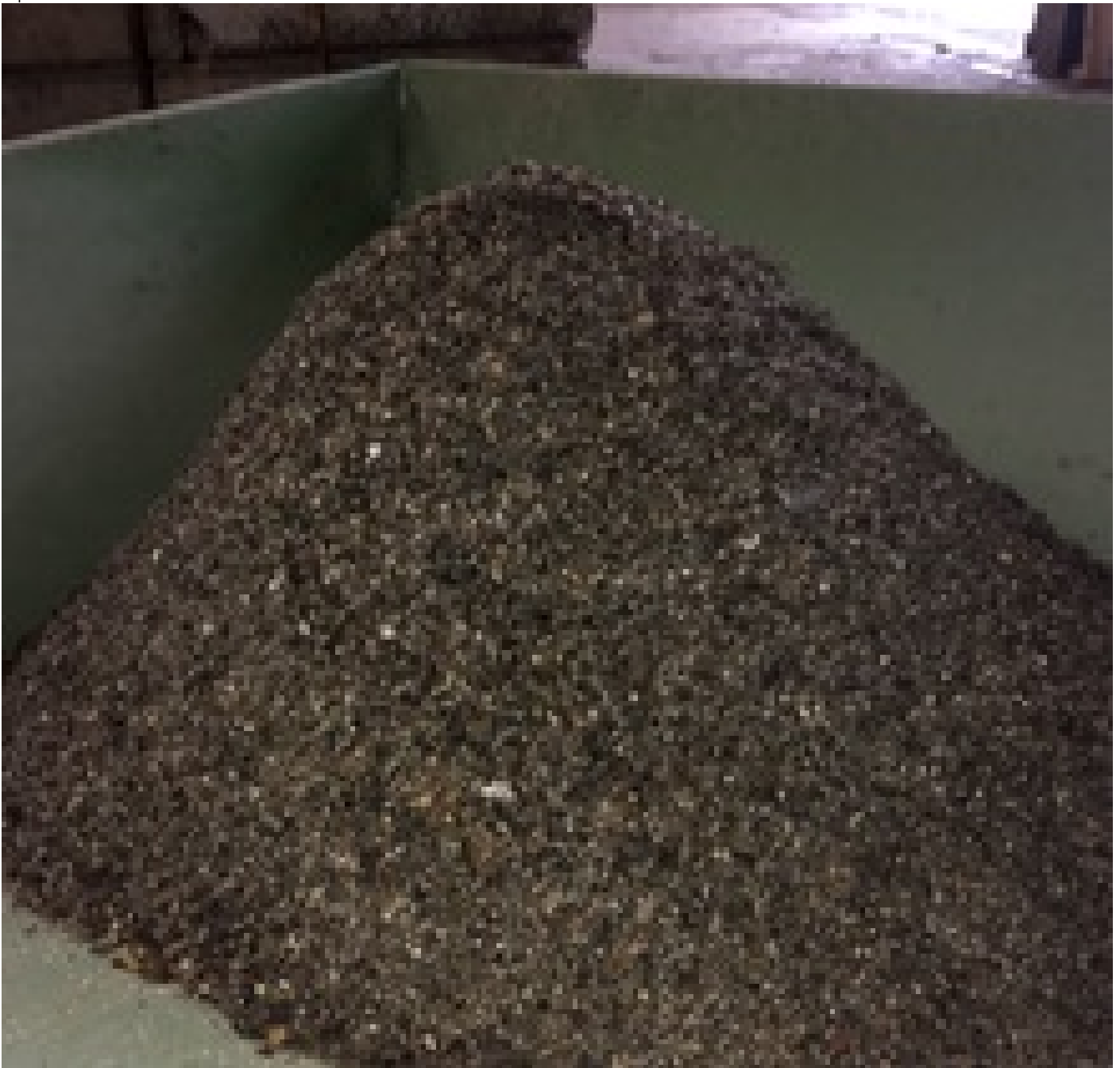
Bild 2: ausgetragener und gewaschener Schwerstoff/Sand
