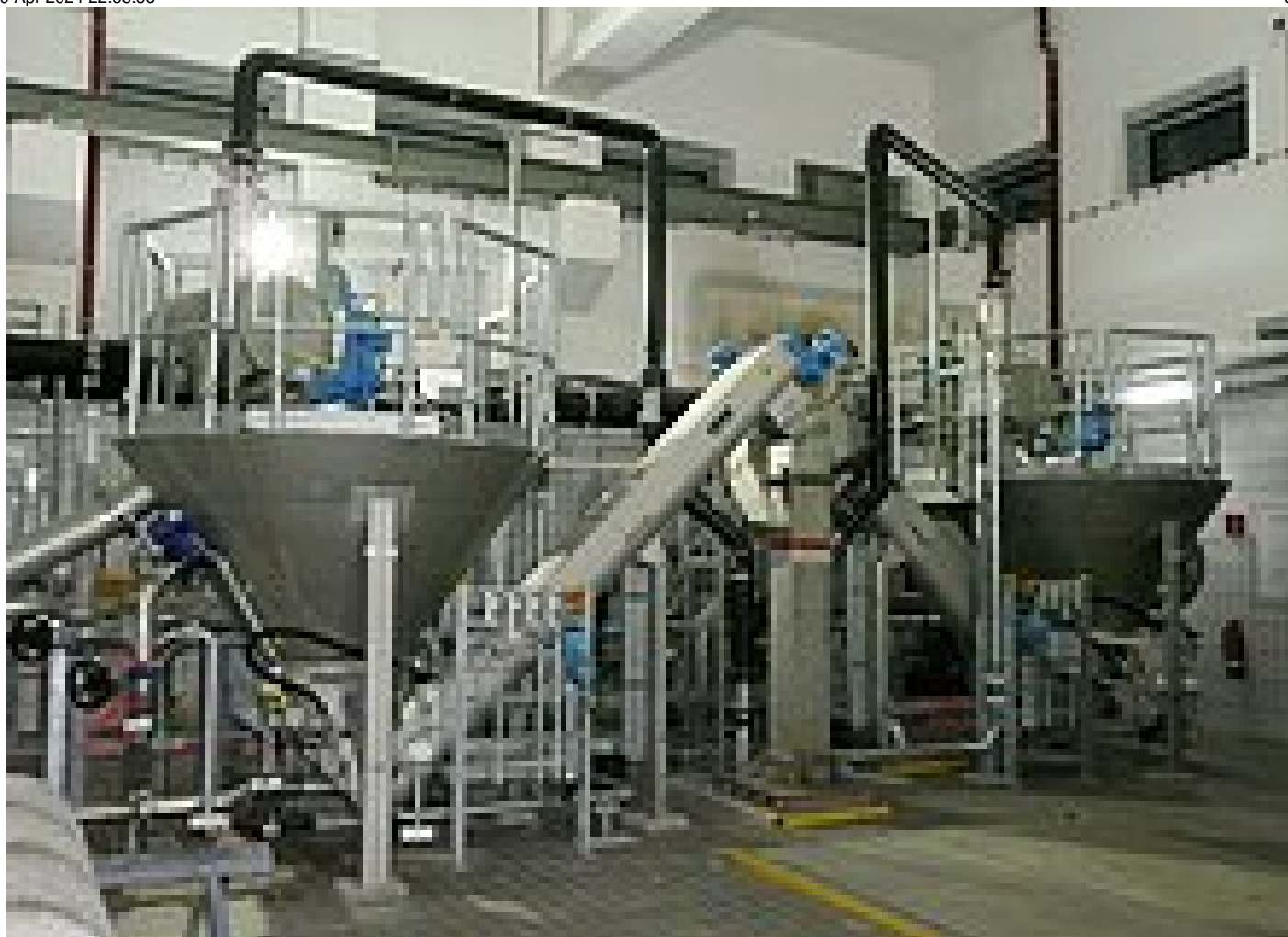
Bereits seit 2011 im Einsatz – HUBER COANDA-Sandwaschanlagen vom Typ RoSF 4 BG 16 l/s
