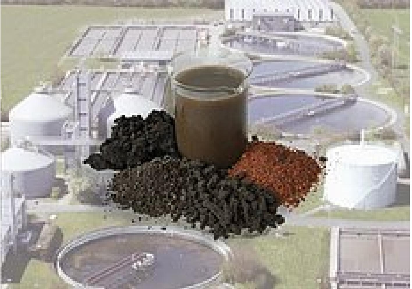
Je besser Abwasser gereinigt wird, um so mehr Klärschlamm fällt dabei an. Als Primärschlamm werden im Rohabwasser enthaltene Feststoffe abgetrennt. Sekundärschlamm ist abgetrennte Biomasse (Überschußschlamm) aus der biologischen Reinigungsstufe. Hinzu kommt gegebenenfalls noch Tertiärschlamm von einer weitergehenden chemisch/physikalischen Reinigungsstufe.
