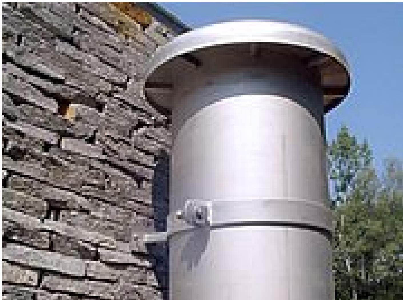
Be-/Entlüftungskamin DN 150 (DA = 154 mm), mit insektensicherem Edelstahlsieb, Maschung 1x1 mm, freier Querschnitt 37%, mit angeschweißter Haube, aus Edelstahl, Werkstoff-Nr. 1.4307 (AISI 304 L).
