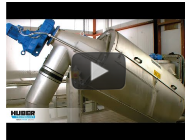
Video: HUBER Schneckeneindicker S-DRUM - hier auf einer kommunalen Kläranlage https://www.youtube.com/watch?v=C1IZm6MYjWo
