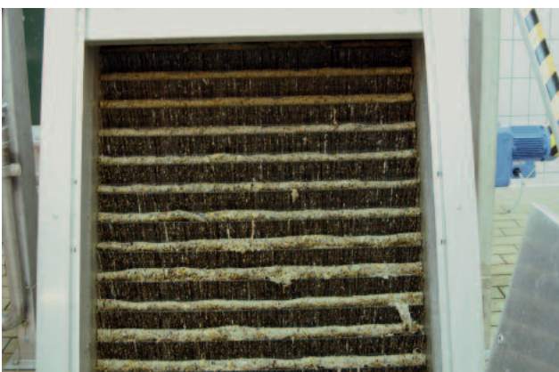
Mit dem HUBER Stufenrechen STEP SCREEN® SSV sind sehr große Abscheideleistungen durch feine Spaltweiten und sich bildenden Rechengutteppich realisierbar.
