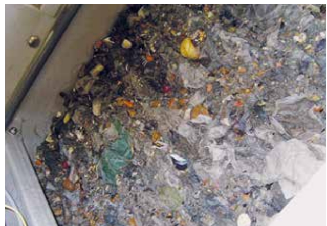
HUBER Stufenrechen STEP SCREEN® SSF: Die Abscheideleistung ist durch eine feine Spaltweite und sich bildenden Rechengutteppich realisiert. Der Selbstreinigungseffekt wird durch ein bewegliches Lamellenpaket gewährleistet.
