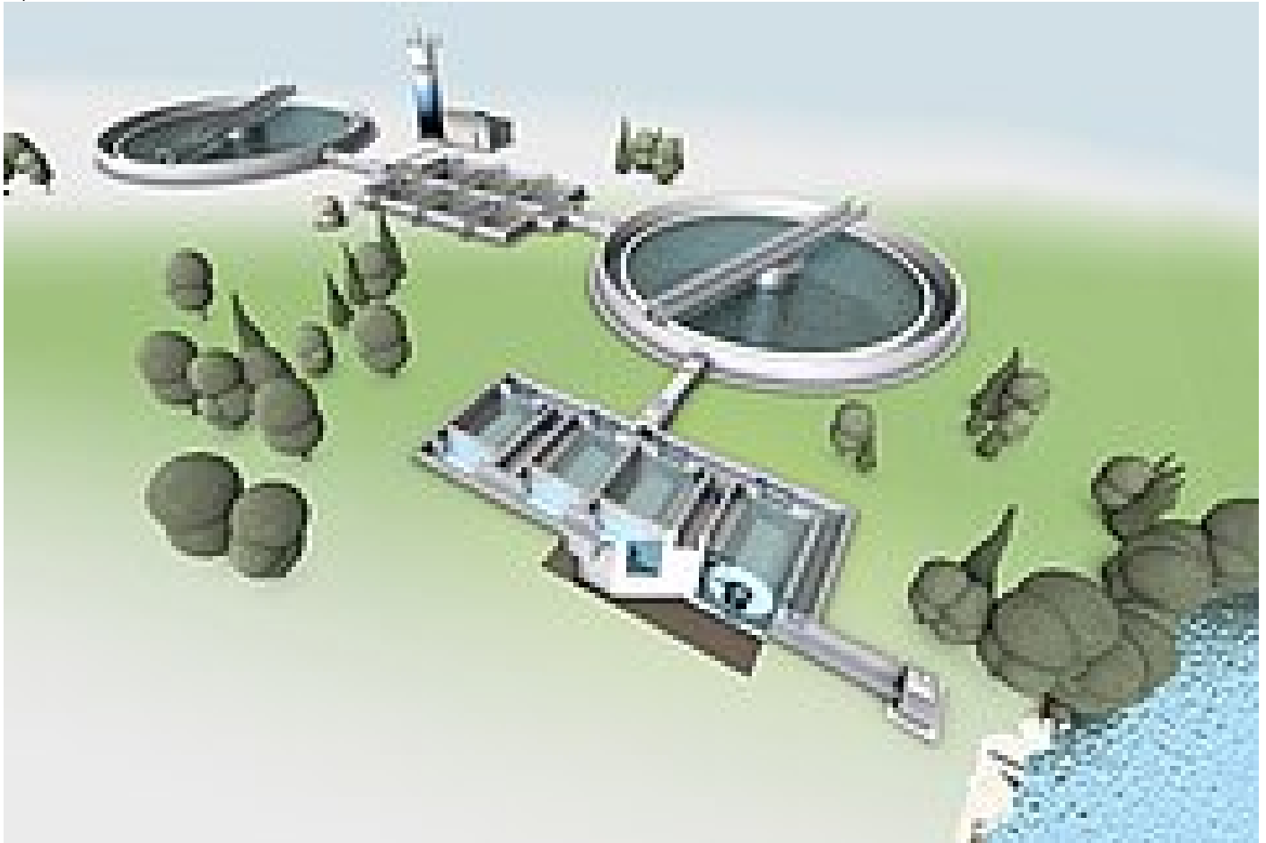
Procedimento PAC ("procedimento di Ulm") con installazione a valle del filtro a dischi HUBER RotaFilt® come filtro di affinamento
